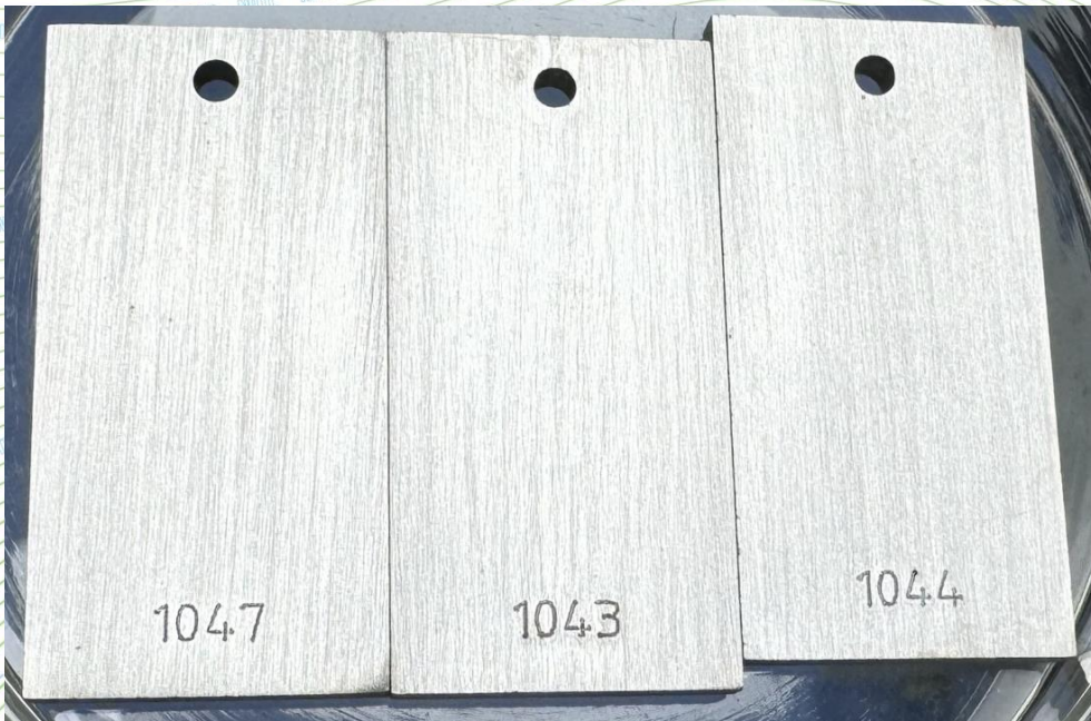
金属腐蚀性试验后金属试片照片
