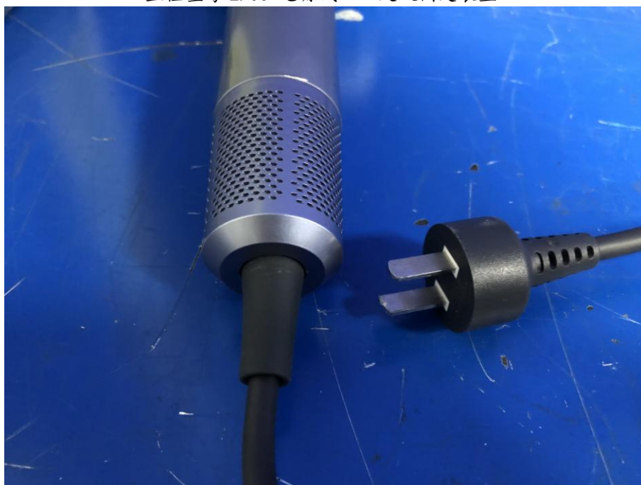
主检型号 LF03 电源线入口处及固定装置
