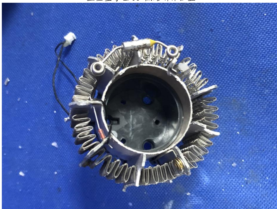
主检型号 LF03 热熔断体位置
